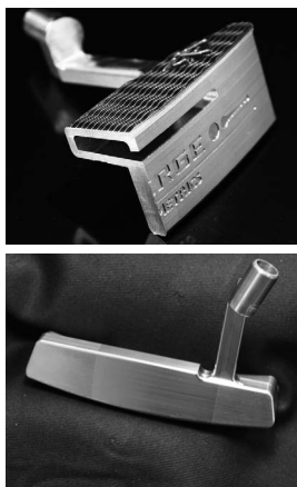
3 拡散接合した中空域を持つ母塊を削り出してヘッドを作る。
